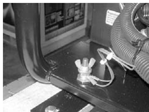
Figura 3-1. Conexión a tierra del generador
