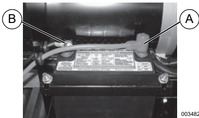
Figura 4-7. Conexión de la batería
