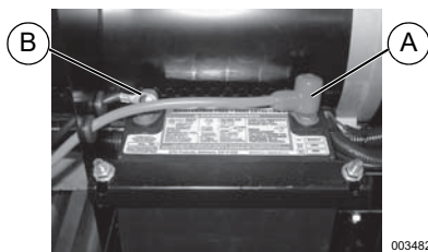
Figura 2-13. Conexión de la batería
