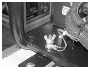
Figure 3-1. Mise à la terre de la génératrice
