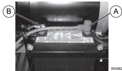
Figure 2-13. Raccorder la batterie
