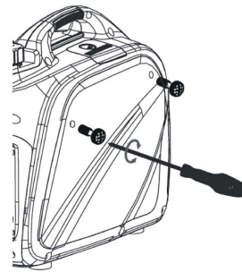
Figura 4-1. Remueva la cubierta lateral
