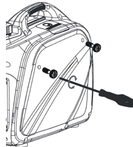
Figura 2-8. Remueva la cubierta lateral
